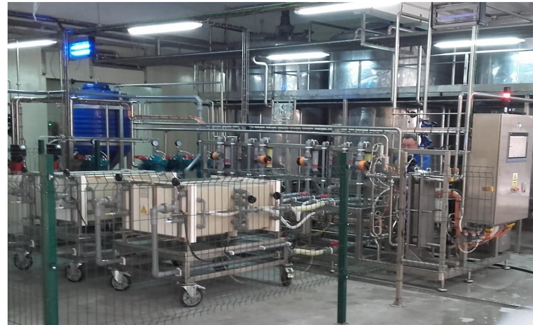
Установка EMU-2 для деминерализации кислой сыворотки, 20% СВ (качество продуктов D50, D70). Украина
