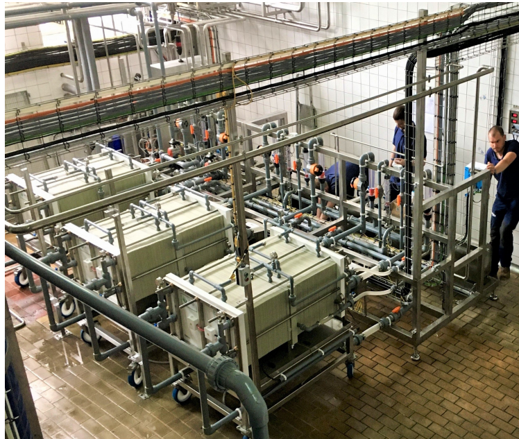
Установка EMU-3 для деминерализации кислой сыворотки, 24-26% СВ (качество продуктов D50, D70, D90). Польша
