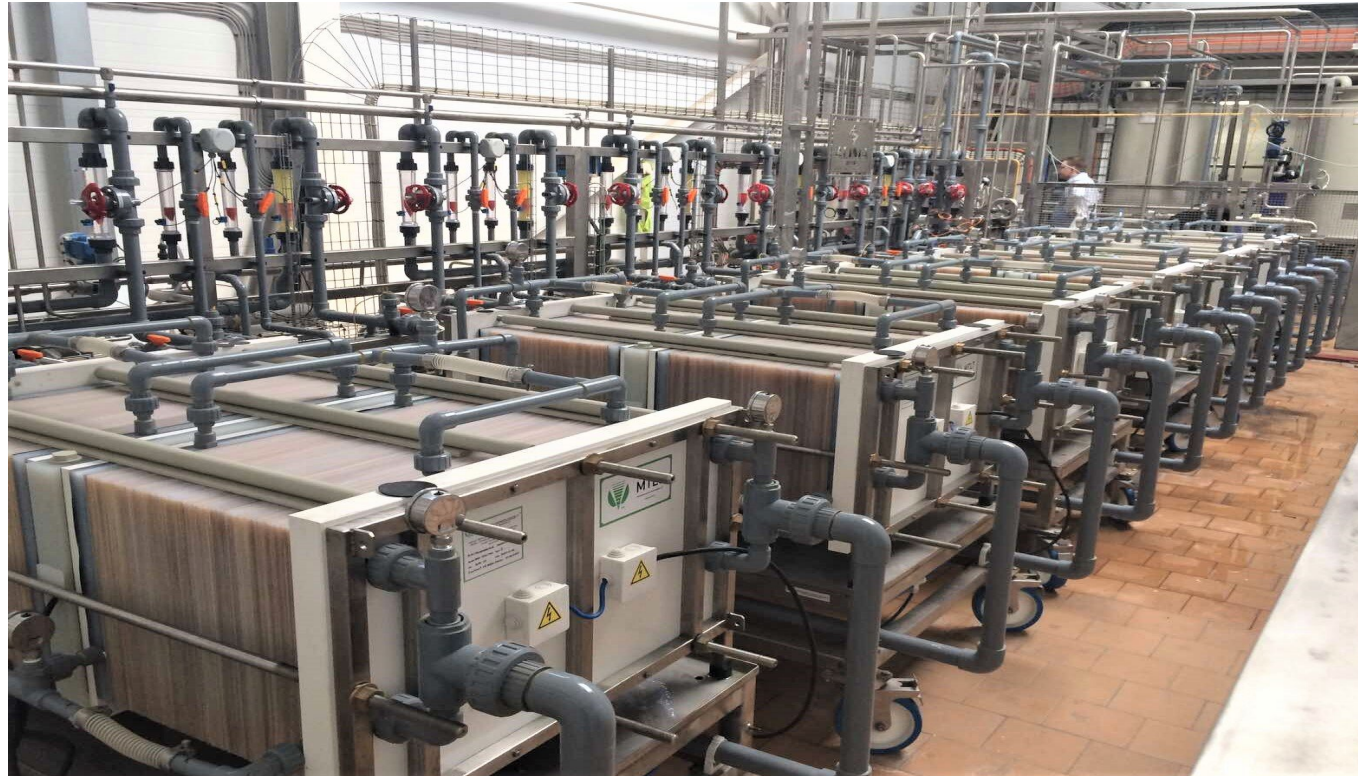
Установка EMU-6 для деминерализации кислой и сладкой сыворотки, 24-26% СВ (качество продукта D70). Россия
